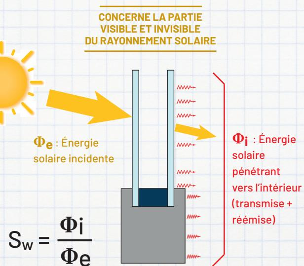
Plus le  $S_w$  est élevé, plus la fenêtre laissera passer l'énergie solaire.
